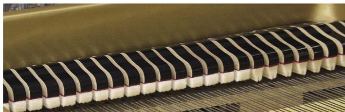
Die Tastaturmechanik hebt nur die Dämpfer der einzelnen gespielten Tasten an, wogegen das Betätigen des Dämpferpedals alle Dämpfer anhebt. Dies ermöglicht allen Saiten im Einklang zu resonieren und so den einzigartigen Klang eines Flügels, auch während des Ausklingens, zu erzeugen.
